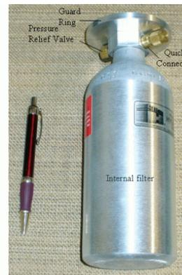
**Le stockage d'hydrogène** sous forme solide, s'appuie sur l'utilisation d'hydrures, une poudre métallique qui absorbe et stocke des quantités significatives d'hydrogène à basse pression et température ambiante.
